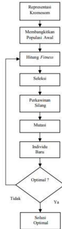
Gambar 1. Langkah-Langkah Algoritma Genetika
