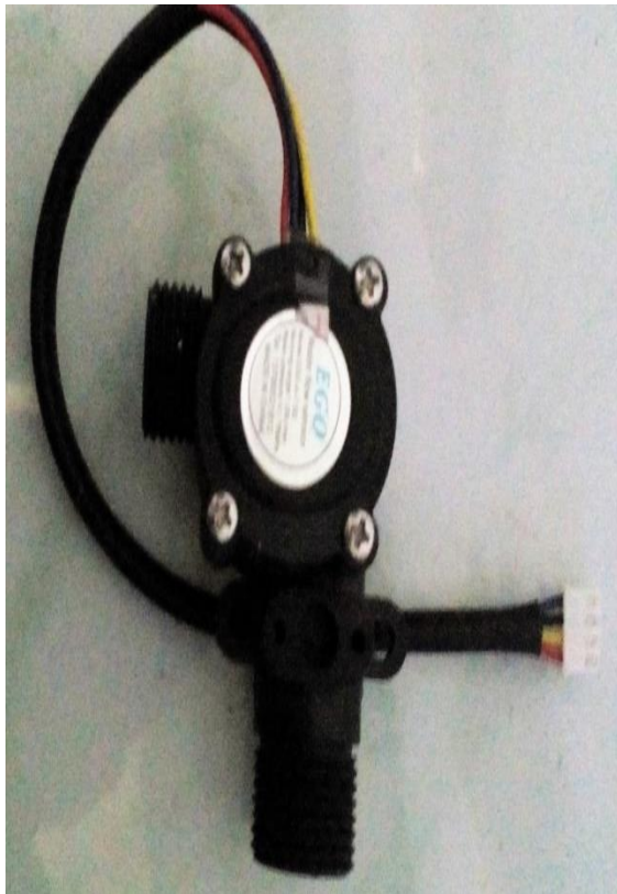
Gambar 3. Sensor flowmeter air EGO yang digunakan pada penelitian
