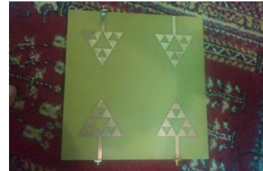
Gambar 3. Gambar Prototipe Antena MIMO Sierpinski Gasket
