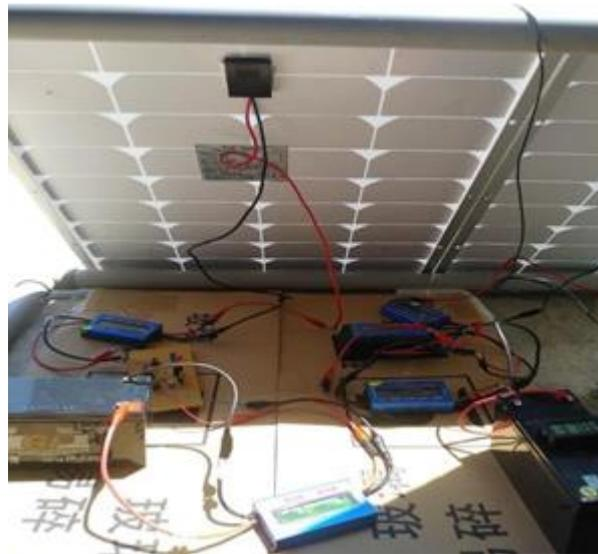
**Gambar 2.** Penyediaan eksperimen untuk bateri asid plumbum 12V
