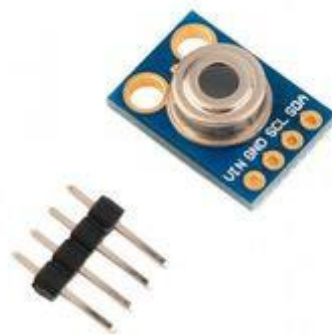
Gambar 1 : wujud fisik sensor MLX90614 (modul GY906)
