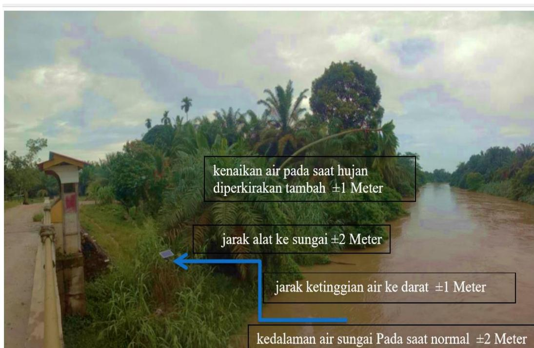
**Gambar 7.** Peletakan Alat
