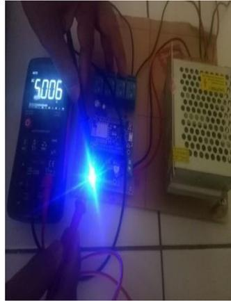
**Gambar 6.** Pengukuran nilai tegangan pada regulator
