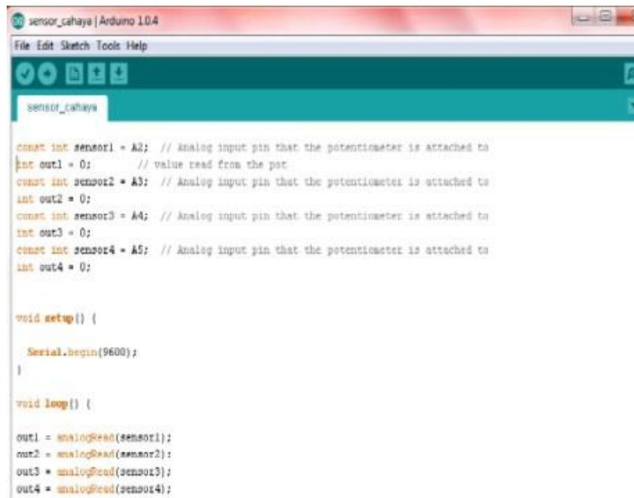
**Gambar 12. Penulisan Program Arduino**
